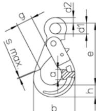
Große Öse, daher auch für Seile und Hebebänder verwendbar. Schließt und verriegelt automatisch. Nicht für geschweißtes System verwendbar!
